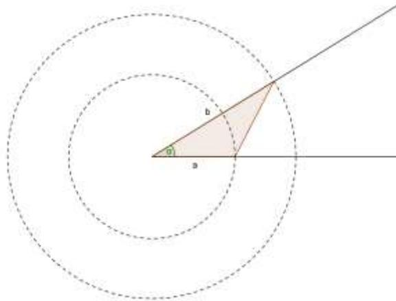
Otros dos triángulos pueden formarse marcando sobre uno de los lados del ángulo un segmento de longitud  $b$  y una circunferencia de radio  $a$  con centro en el extremo del segmento anterior que no sea el vértice el ángulo.
