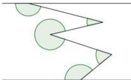
Solución: Cerrando la poligonal con una recta perpendicular a las rectas paralelas, como lo indica la figura:
