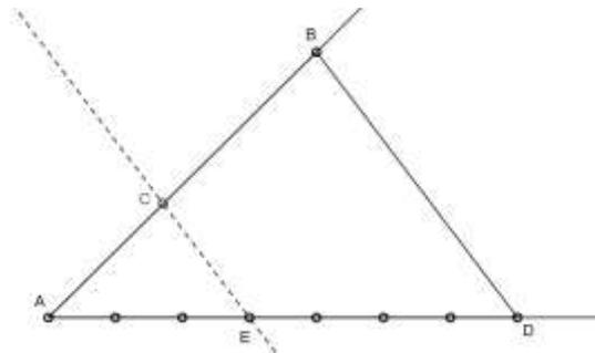
unimos el punto  $D$  con  $B$  y trazamos una paralela por  $E$  al segmento  $BD$  para cortar a  $AB$  en el punto  $C$ . Por el teorema de Tales resulta:
